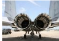
F-15搭載F100エンジン (機体後部より)
